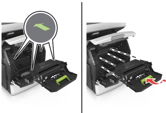
**Примечание.** Для подсказки используйте стрелки на боковой части принтера.
