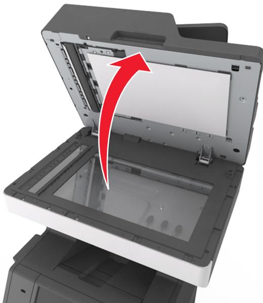
6 При замятии бумаги в нижней дверце УАПД или в выходном лотке УАПД откройте нижнюю дверцу УАПД и возьмите замятую бумагу с каждой стороны.
