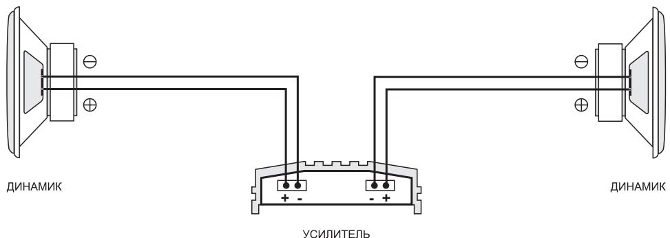
**Б) Схема подключения компонентных динамиков.**
