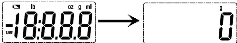
2. Поместите емкость на весы. На дисплее отобразится вес емкости.
