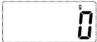
7. Если ни одна из клавиш не будет нажата, весы автоматически отключатся через 1 минуту. Кроме того, весы можно отключить вручную. Для этого нажмите и удержите в течение 2 секунд клавишу ON/OFF/TARE.
