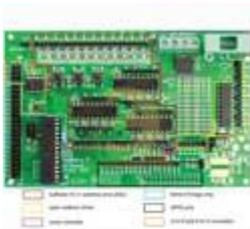
Плата расширения портов ввода / вывода Gertboard для Raspberry Pi
