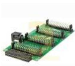
Плата расширения PiFACE - PI RACK FOR RASPBERRY PI
