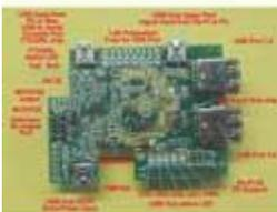
4-х портовый USB хаб, RTC, ЦАП, датчик температуры и USB консоль для Raspberry Pi
